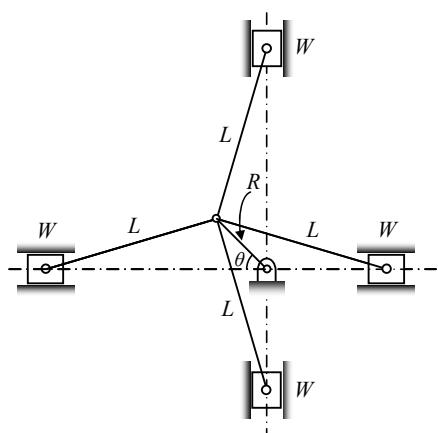
(۱) در موتور چهار سیلندر شعاعی رو برو که زاویه‌ی بین صفحه‌های سیلندرها  $90^\circ$  است، جرم رفت و برگشتی هر سیلندر  $W$ ، طول لنگ برابر  $R$  و طول دسته شاتون هر سیلندر برابر  $L$  است.
