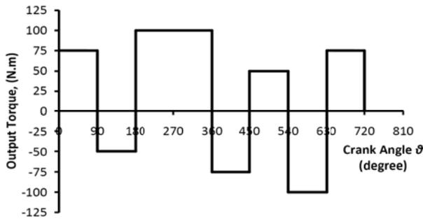
(۱) گشتاور خروجی یک موتور احتراقی تک‌سیلندر مطابق شکل روبرو
